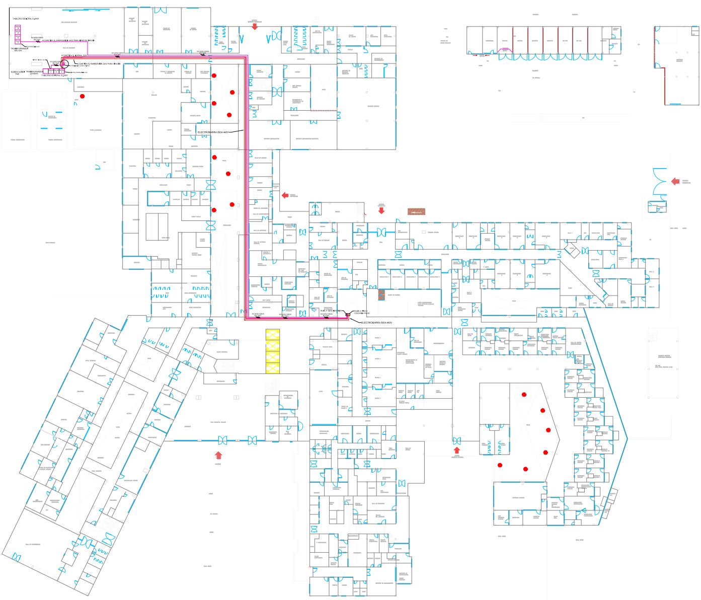
PLANTA PISO 1 ACOMETIDAS S. NORMAL Y EMERGENCIA
